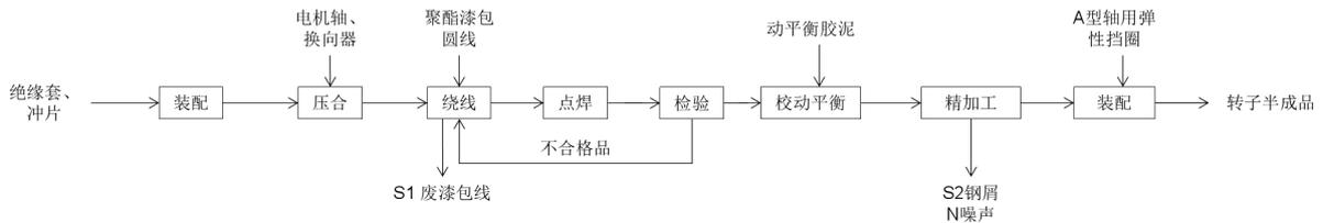
图 5-1 转子生产工艺流程图
