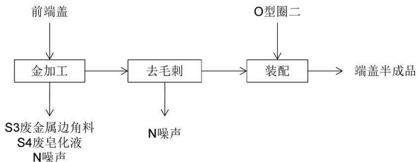
图 5-3 端盖生产工艺流程图
