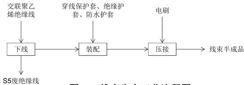
图 5-4 线束生产工艺流程图
