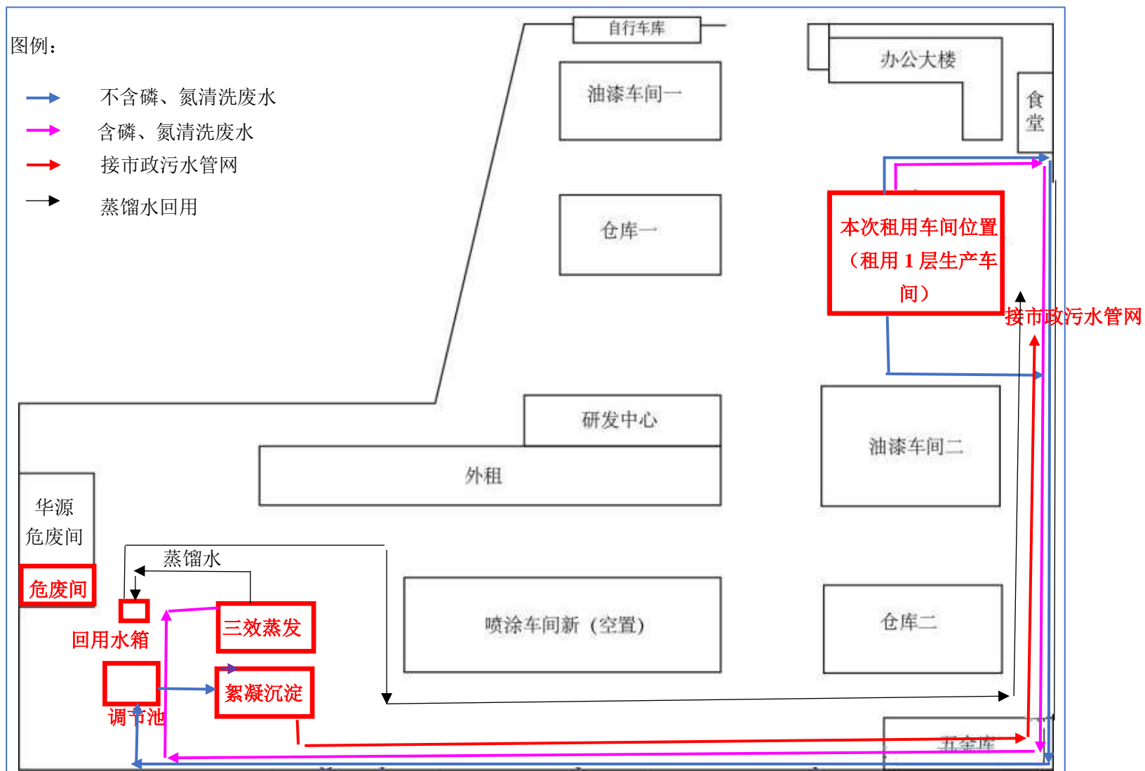
附图 2 项目在华源漆业内平面布置及排水管网示意图
