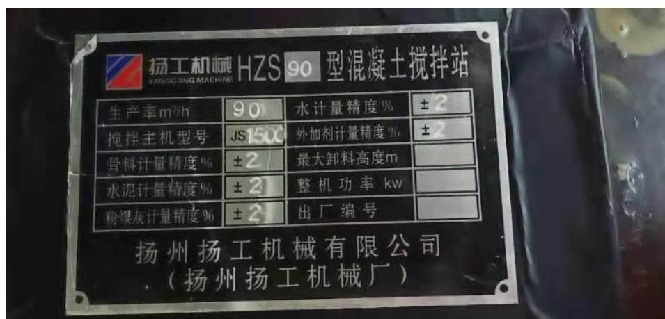
图 2.6-1 实际搅拌机型号
